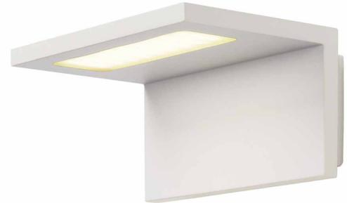
Die mit einer leistungsstarken, warmweißen LED bestückten Wandleuchte ANGOLUX WALL ist in mehreren Farbversionen verfügbar. Der elektrische Anschluss der aus Aluminium gefertigten Leuchte erfolgt durch den verbauten Treiber an 230V Netzspannung. Durch die Schutzart IP44 ist die Leuchte für den Außenbereich geeignet. Die Lampen können in der Leuchte nicht ausgetauscht werden.
