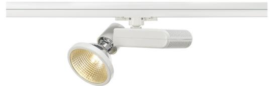
Dreh- und schwenkbarer Hochvoltstrahler D-RECTION ELITE G12 mit passendem Adapter für das 3 Phasen Hochvolt Schienen-System. Um diesen Profi-Strahler mit verbautem G12 Sockel an jeden Einsatzort anzupassen, sind separat Reflektoren mit diversen Abstrahlwinkeln verfügbar. Das zum Betrieb der Entladungslampe notwendige elektronische Vorschaltgerät, sowie ein Dekoring befinden sich im Lieferumfang.
