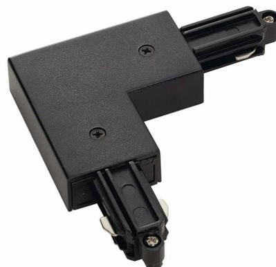
Eck-Verbinder mit Einspeisemöglichkeit für das Hochvolt 1Phasen-Aufbauschienen-System. Der in mehreren Farbversionen verfügbare Verbinder ist mit Erdleiter links oder rechts erhältlich. Detaillierte Informationen entnehmen Sie bitte der Planungshilfe.
