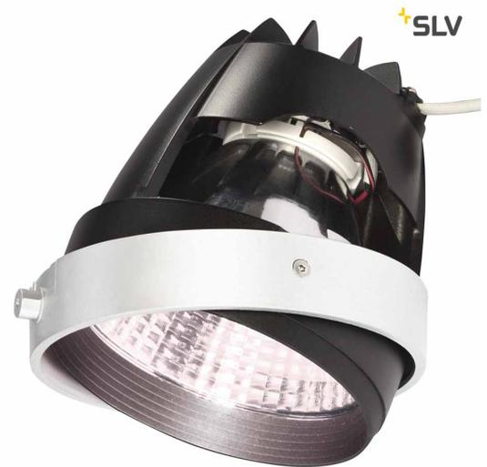
Das COB LED Modul wurde für den Einsatz in AIXLIGHT PRO Einbaurahmen konzipiert. Dieses Spezialprodukt ist für die Ausleuchtung von Fleischwaren und nicht zur allgemeinen Raumbelichtung geeignet. Das kaltweiße COB LED Modul ist in weiß oder silbergrauer Ausführung in verschiedenen Abstrahlwinkeln erhältlich. Zum Betrieb wird ein LED Treiber mit einem Konstantstrom von 700mA benötigt. Nicht passend für Flat-Einbaurahmen.
