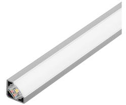
GLENOS Eck-Profil 2720 in 1 m Länge exklusive Abdeckung zur Montage von LED Strips bis 10 mm Breite. Das in weiß matt und aluminium eloxiert erhältliche Profil ist ideal zur Montage in Ecken oder an Decken, zur Unter-Schrankmontage oder zum Einsatz im Mes
