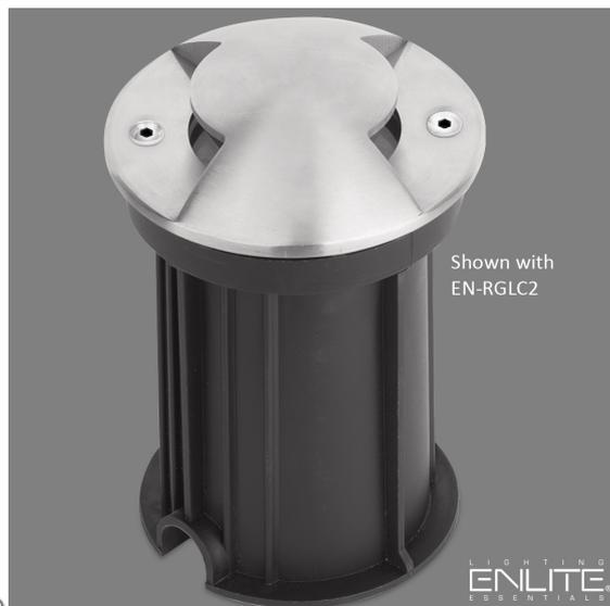
G-Lite™ ist die neue Enlite Serie von IP67 widerstandsklassifizierten Bodeneinbauleuchten aus 304 Edelstahl. Ideal geeignet für dezente Beleuchtungsinstallationen in häuslichen und kommerziellen Anwendungen. Austauschbare Blenden mit bis zu 4 seitlichen Öffnungen ermöglichen Designflexibilität (**Blenden separat erhältlich**).
